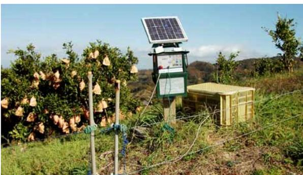
写真3 電気柵の電源本体（ソーラー充電タイプ）
